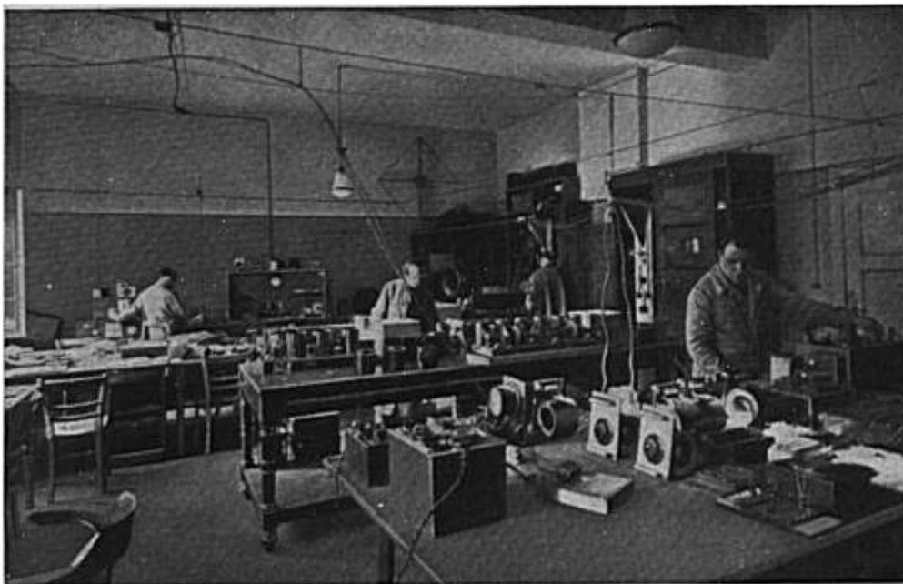
Bild 17. Blick auf einen Teil des Empfängerlaboratoriums im Telefunkenhause, Hallesches Ufer 14. Durchmessung von Empfängergeräten nach wissenschaftlichen Methoden.
