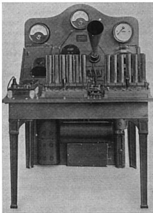
Bild 225. Station zum Senden und Empfangen von Telegraphie und Telephonie mit durch Serienlichtbögen erzeugten Schwingungen (1906/1907).
