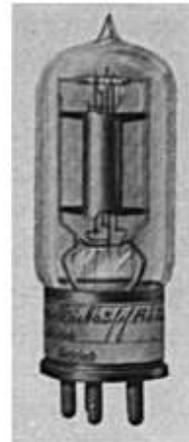
Bild 74. Röhre mit Raumladungsgitter RE 26, Telefunken-Doppelgitterrohr in früher Ausführung mit Wolframfaden.
