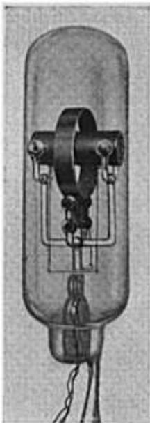
Bild 80. Glimmentladungs- Verstärker nach Kossel mit Kanalstrahlen - Steuerung durch ein Hilfsfeld.
