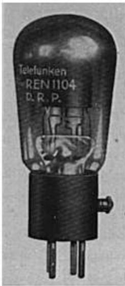
Bild 76. Indirekt geheizte Rundfunkempfangsröhre REN 1104 für Speisung aus dem Wechselstromnetz über einen Transformator.
