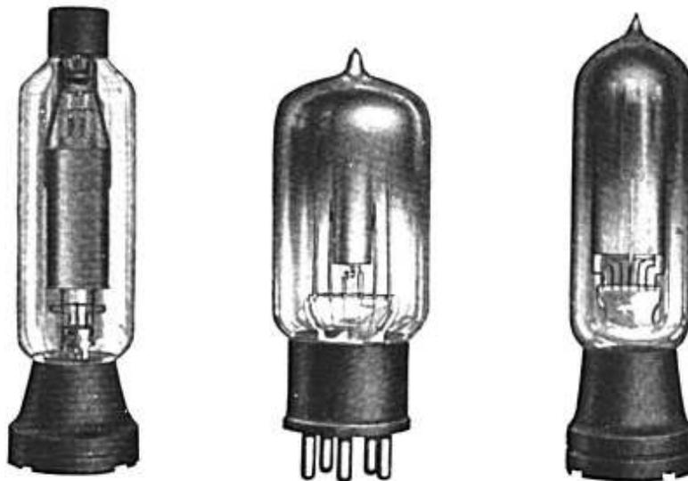
Bild 104 (links). Verstärkerröhre RV 24 mit Wolframsfaden. Endstufe des Mikrophonverstärkers für Rundfunksender. Vielfach auch als Modulationsröhre für Gittergleichstromtelephonie benutzt.
