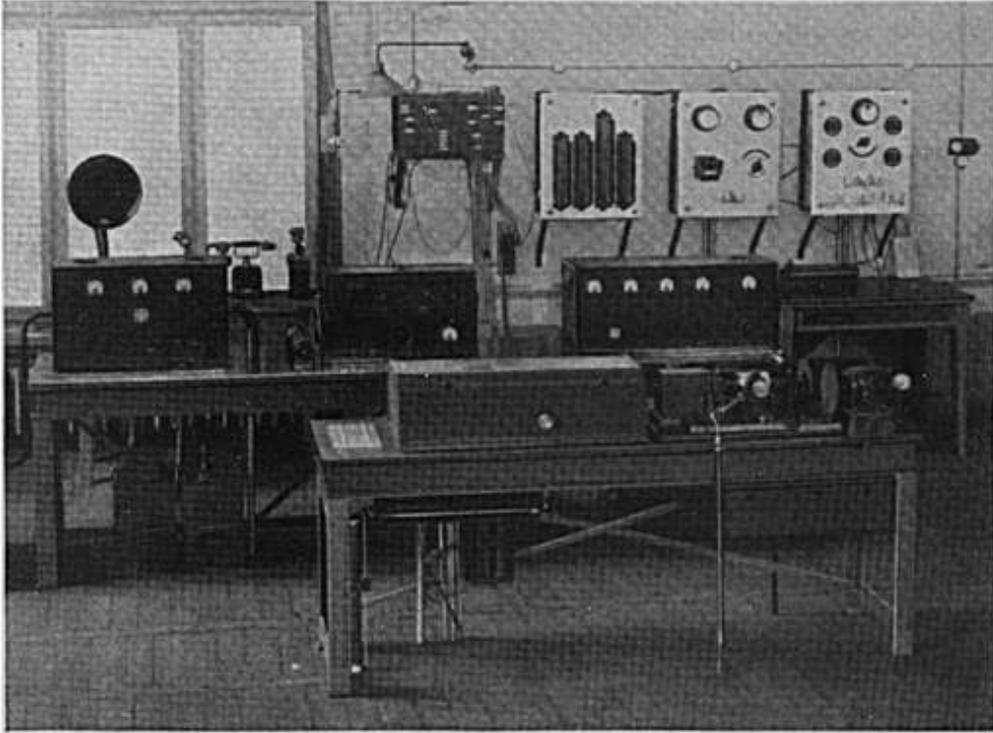
Bild 46. Bildfunk im Berliner Haupttelegraphenamts: Unsere Geräte für Betriebsversuche und Vorführungen. In zweiter Reihe die Verstärker für Photostrom, Schreibstrom und Stimmgabelton.
