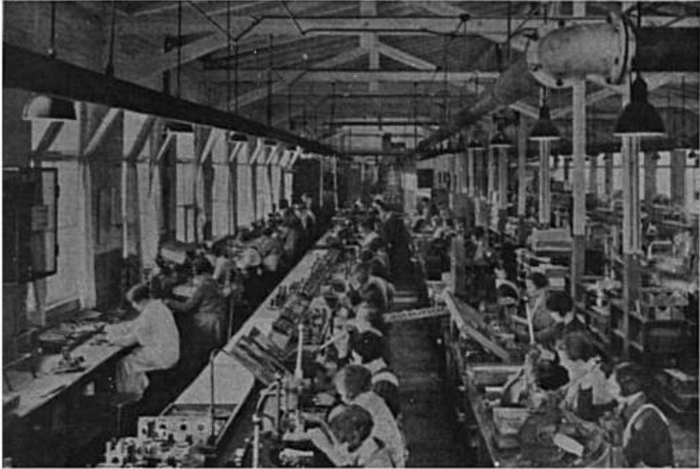
Bild 131. Aus den Funkwerkstätten der Siemens & Halske A. G., Wernerwerk. Montage des Telefunken-Rundfunkempfängers „Arcolette 3“.
