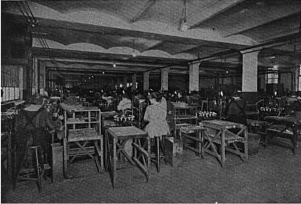
Bild 100. Die Serienfabrikation von Telefunken-Rundfunkempfangsröhren bei der Osrarn-Kommanditgesellschaft, Werk A, Sickingenstraße. Einer der Säle für maschinelle Einschmelzung der Elektrodenträger.
