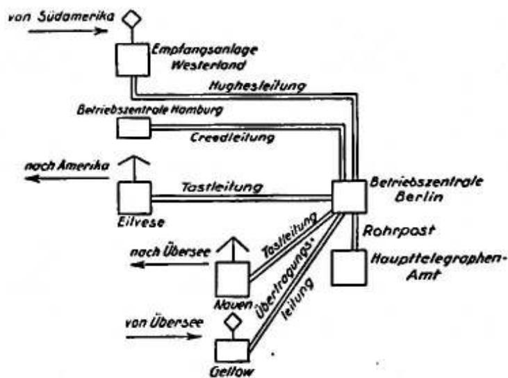
Bild 169. Betriebsplan der Telegraphieranlagen von Transradio im Jahre 1925.
