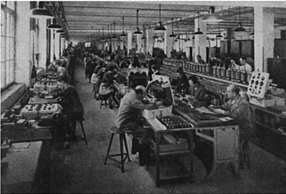
Bild 122. Aus den Funkwerkstätten bei der A. E. G. Im Vordergrund Montage von Funkpeilempfängern, im Hintergrunde Zusammenbau von Hochfrequenzsperrern für die EW-Hochfrequenztelephonieanlagen.
