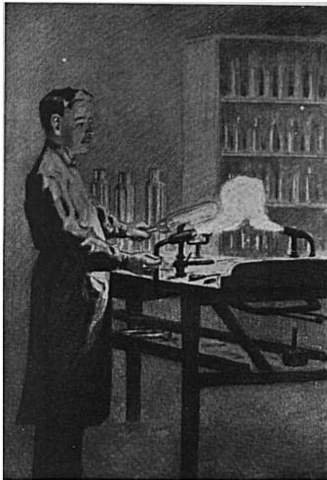
Bild 36. Senderröhrenherstellung: Glasbläser beim Erhitzen und Verblasen der mächtigen Kolben für stärkere Typen. Wiedergabe eines von H. Otto-Werniger gezeichneten Titelbildes der Telefunken-Zeitung.
