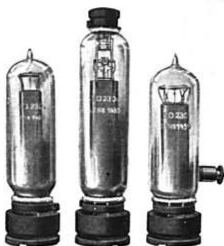
Bild 99. Senderöhren mit Sparfäden (Thoriumfäden) zur Verringerung des Heizwattbedarfs, für bis zu etwa 75 Watt Hochfrequenzleistung bei 1000 Volt Anodenspannung. Rechts: Zweigitterröhre für eine besondere Modulationsmethode.
