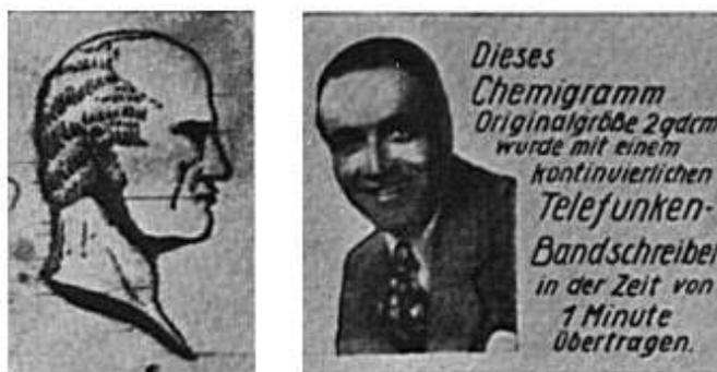
Bild 39. Elektrochemische Strichtelegramme. Links das Bild Volta's, übertragen mit historischen Apparaten von Caselli in Como, September 1827, binnen 15 Minuten. Rechts Chemigramm eines modernen Telefunkenengerätes.
