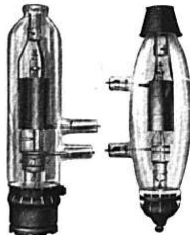
Bild 97. Luftgekühlte Kurzwellensenderöhre RS 229 für 400 Watt. Anoden- und Gitterdurchführung getrennt (seitlich). Elektrodenzuleitungen für sehr hohe Blindstromstärken bemessen. Leistungs-Vorstufenröhre moderner Kurzwellensender.
