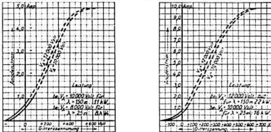
Bild 107. Kennlinien der Wasserkühlenderöhren RS 224 und RS 225.
