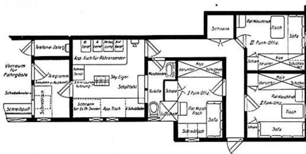
Bild 191. Funkstationsplan des Dampfers „Berlin“.
