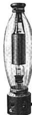
Bild 89 (rechts). Luftgekühlte Hartglas-Senderöhre für 10 Kilowatt bei 16000 Volt Anodenspannung. Gesamthöhe etwa 60 Zentimeter. Nicht normalisiert.
