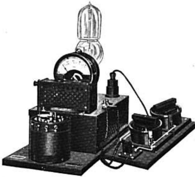
Bild 28. Erster Oberlagerer mit Kathodenröhre (alter Liebenröhre) als Schwingungserzeuger nach Alexander Meißner, Mai 1913. Anodenspannung 220 Volt.
