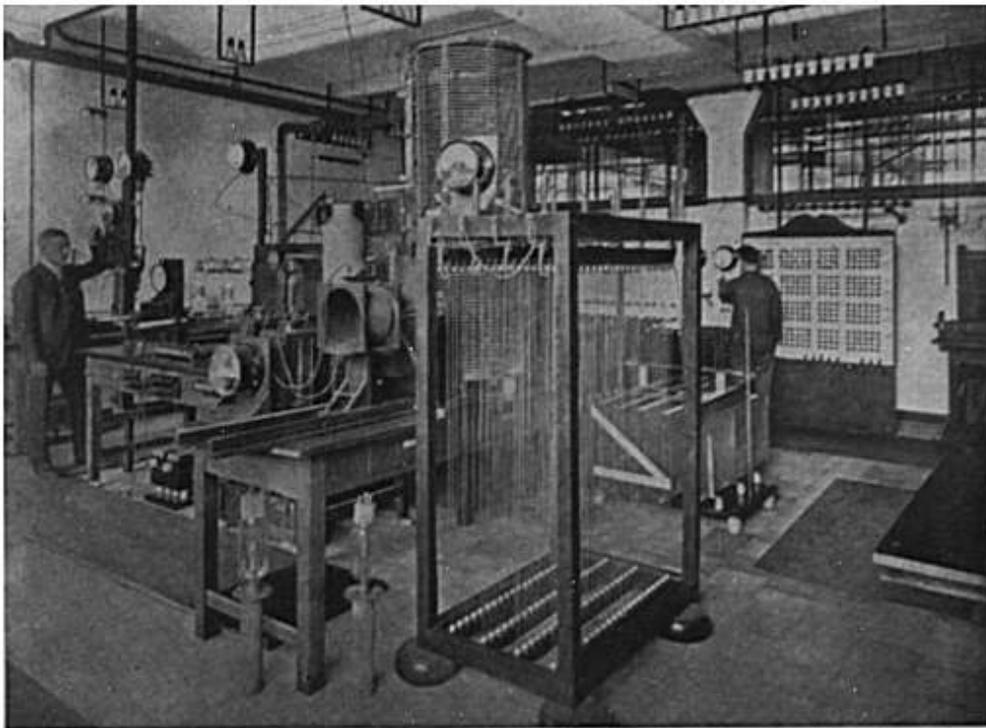
Bild 6. Telefunken-Röhrenlaboratorium Sickingenstraße: Raum für Senderöhrenentwicklung. (Im Vordergrund stehend zwei Wasserkühlrohren (1922). (Siehe auch die Ausführungen von Hans Rukop.)
