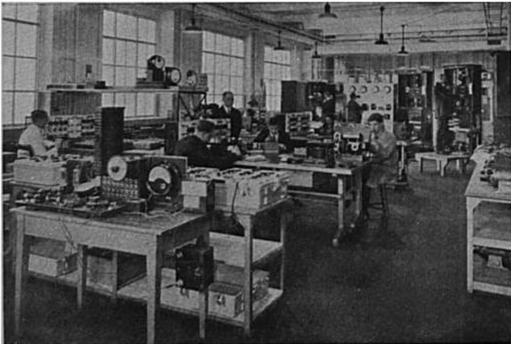
Bild 124. Herstellung von Funkgerät bei der A. E. G. Ein Ausschnitt aus den Prüffeldern. Im Hintergrunde Prüfung von EW-Hochfrequenztelephonanlagen.
