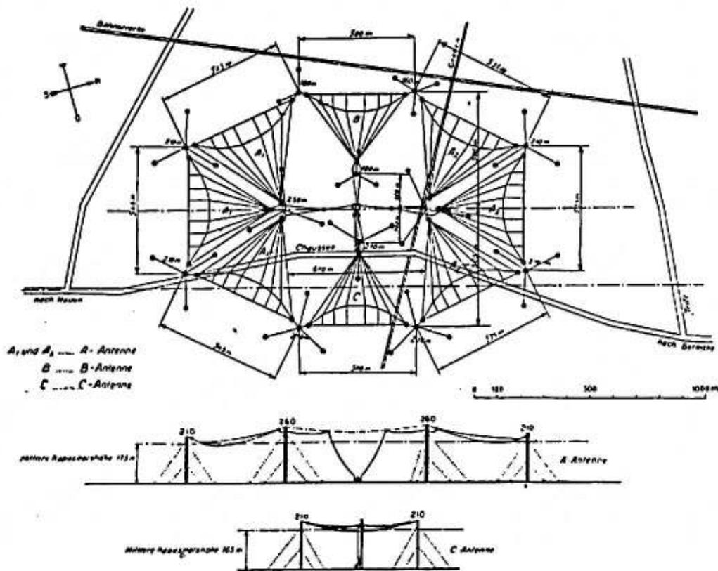
Bild 166. Die Nauens-Antennen von 1924: Vieleckform. Die Amerika-Antenne besteht aus 2 einzeln oder gemeinschaftlich benutzbaren Gruppen  $A_1$  und  $A_2$ , diese wiederum aus je 3 Sektoren. Heute tragen die 12 Masten (Höhe bis 260 Meter) außer den hier gezeigten Flächenantennen noch 4 mehrdrätige T-Antennen
