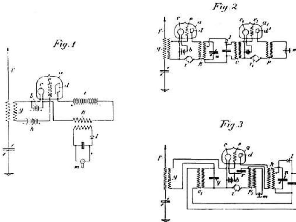
Bild 62. Figurenseite des beschlagnahmten französischen Patentes Nr. 456788 auf den von Bronk'schen Hochfrequenzverstärker mit Schaltungen zur Verstärkung der Empfangsschwingungen vor der Gleichrichtung. Figur 3 zeigt die Reflexschaltung, die Doppelausnutzung der Röhre für Hoch- und Niederfrequenzverstärkung.
