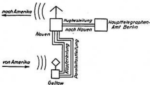
Bild 167. Betriebsplan der Telegraphieranlagen von Transradio im Jahre 1919.
