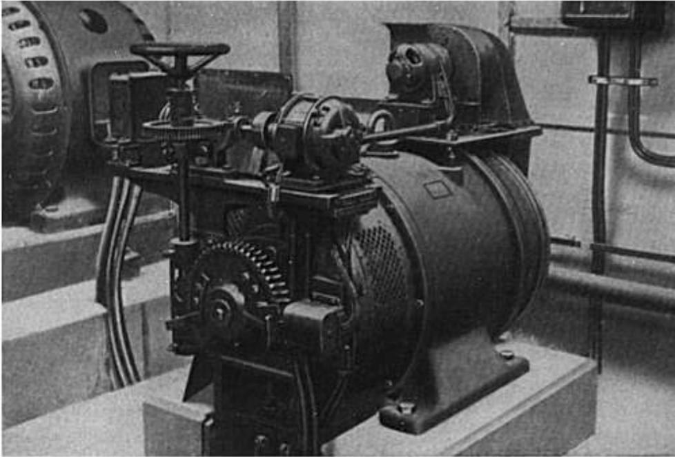
Bild 94. Versuchs- und Prüfanlage für Wasserkühl-Senderröhren im Telefunken-Laboratorium, Wernerwerk, Siemensstadt: Großer Drehtransformator für 120 Kilowatt.
