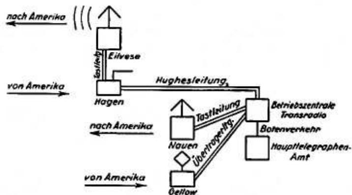
Bild 168. Betriebsplan der Telegraphieranlagen von Transradio im Jahre 1922.
