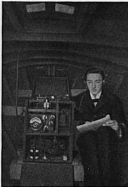
Bild 189. Funkanlage im Motorrettungsboot des Dampfers „Columbus“ mit dem Löschfunkensender und dem Hörempfänger.
