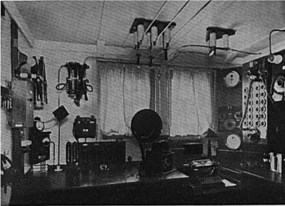
Bild 184. Funkkabine auf dem Dampfer „New York“ der Hamburg-Amerika-Linie. Rechts Röhrensender, in der Mitte Empfänger, links an der Wand Funknosender.
