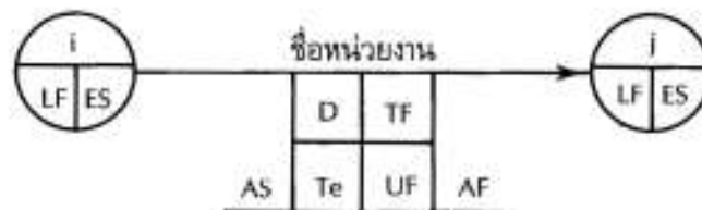
ภาพที่ 11.14 แสดงการปรับปรุงสัญลักษณ์เส้นลูกศรที่ใช้แทนหน่วยงานจากแบบเดิม ซึ่งมีอยู่ 4 ค่า คือ ES, D, TF และ LF เป็นเพิ่มให้มีค่าเวลาอีก 4 ค่า คือ AS, Te, UF และ AF เรียงตามลำดับ
